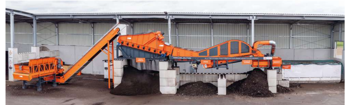
Eine kombinierte Siebanlage mit Störstoffauslesung für den Siebüberlauf inklusive Windsichter, Steinfaller und Magnetabscheider.
