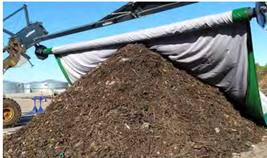
Membranwickler im Einsatz auf einer französischen Anlage
