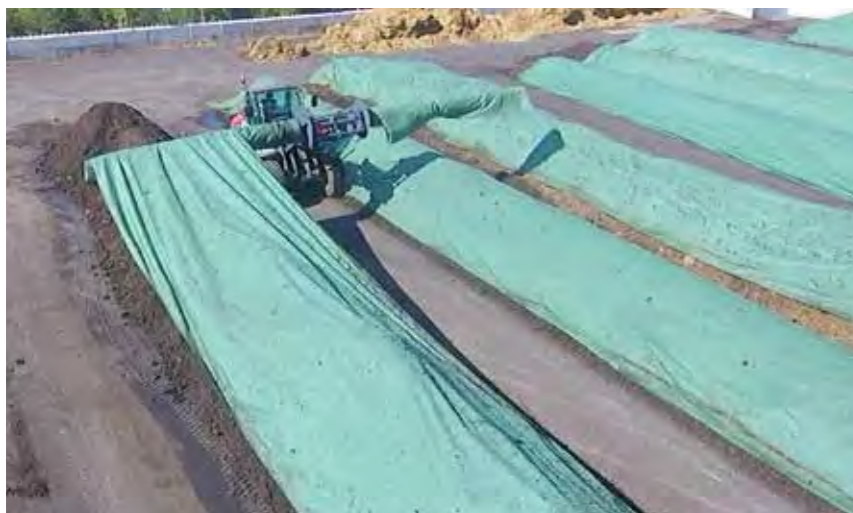
Kompostschutzvlies im Einsatz auf einer österreichischen Anlage
