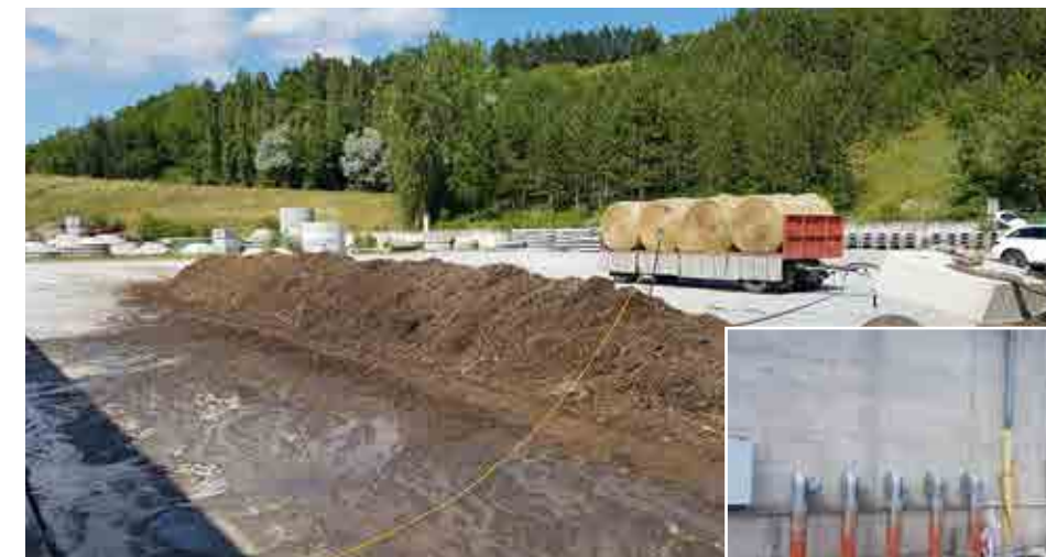
Aufgrund der eingebauten Belüftung muss nur einmal in der Woche umgesetzt werden.
