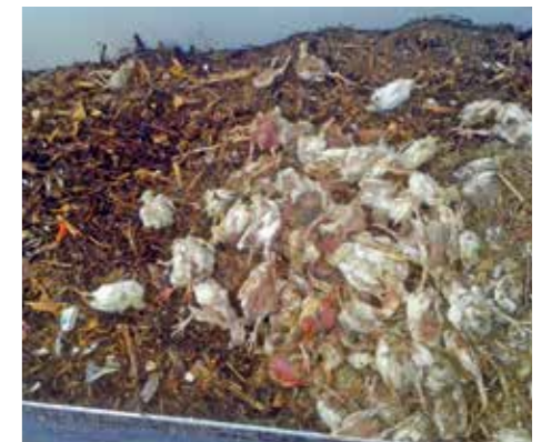
Der CSC-Container wurde schichtweise mit Schlachtabfällen und Strukturmaterial befüllt.
