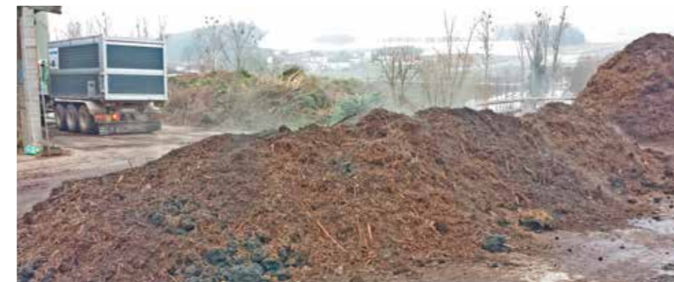
Klärschlamm wurde mit Strukturmaterial abgemischt und zu hochwertigem Qualitätskompost der Klasse A verarbeitet.
